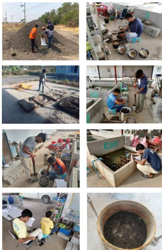
รูปที่ 1 การทดสอบคุณสมบัติทางด้วยวิศวกรรมของวัสดุชุดไสผิวทางแอสฟัลต์ผสมทรายถม
